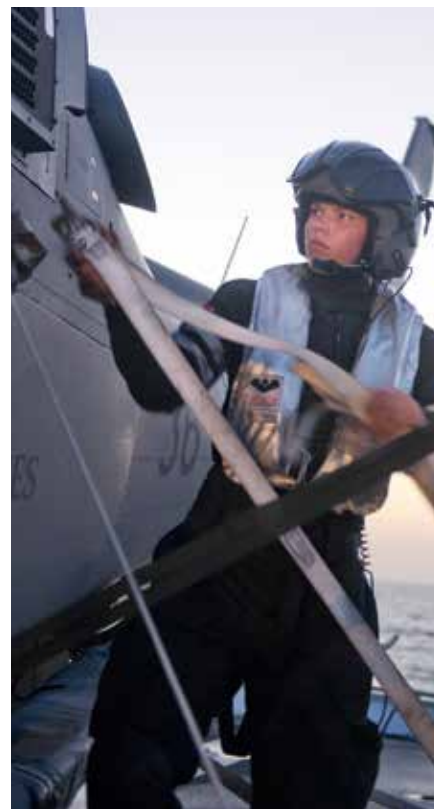
Efter dagens flygningar ser fartygets flight deck team bland annat till att helikoptern blir ordentligt surrad.
