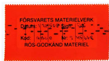
Bild 18:4 - Röd plomberingsetikett används för utrustning som endast får användas inom svenskt territorium.
