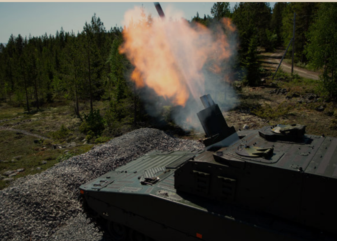
Dubbelt upp. Tack vare att vagnarna har två eldrör istället för ett, som i tidigare system, kan de skjuta fler granater.
