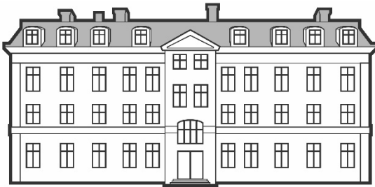
Bild 5 Exempel på byggnad som normalt projekteras som Br1. Illustration Cecilia Nygren, Försvarsmakten.
